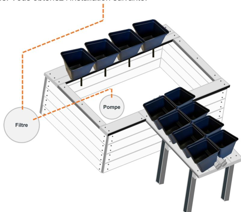
**Étape 6.** Prenez le tuyau qui sort du filtre et qui monte vers les tours, et coupez-le à hauteur de la surface des seaux. Prenez, dans ce qui a été fourni, le tuyau flexible 19 mm muni d'un robinet et d'un connecteur T, et insérez celui-ci à l'aide d'un décapeur ou d'un sèche-cheveux à l'endroit que vous venez de couper. Ajoutez à l'autre extrémité le dernier robinet fourni.
